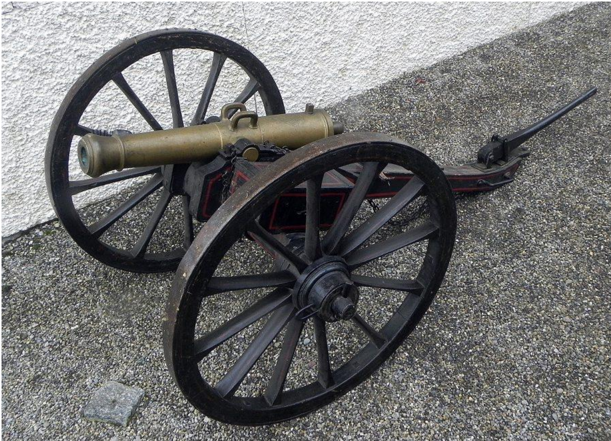
Halbpfünder Vorderladerkanone schussbereit mit umgelegtem Richtbaum. Kanonenrohr mit glattem Lauf, Kaliber 40 mm, Lauflänge 600 mm, Kugelgewicht 250 g.
